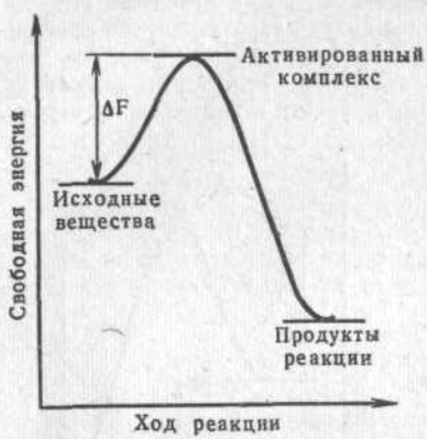
Рис. 36. Энергетическая диаграмма реакции в теории переходного состояния
